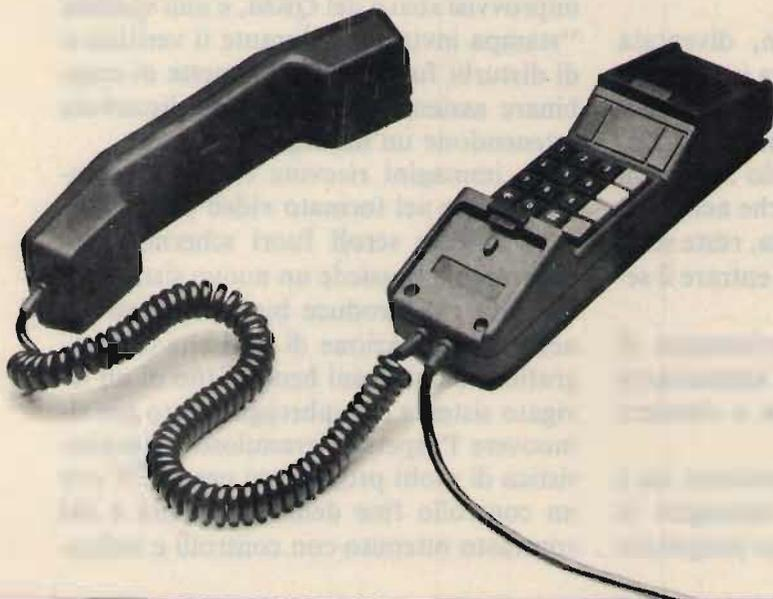
Questa cornetta telefonica, unica nel suo genere, è stata realizzata dalla Electronic System per facilitare l'uso dei sistemi telefonici via radio veicolari.
